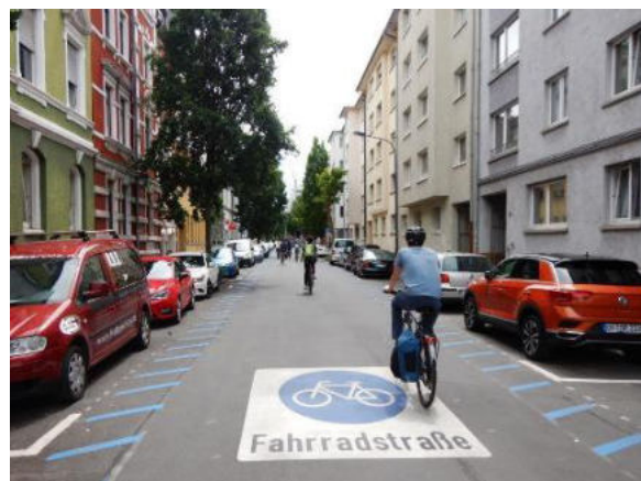
Abbildung 11: Eingerichtete Fahrradstraße mit taktilem Sicherheitstrennstreifen zum „Gefahrenbereich Kfz-Türen“ in Offenbach am Main (Quelle: Eigene Aufnahme)
