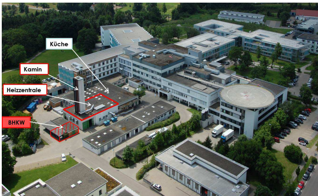
Abbildung 7: Geplanter Einsatz eines Blockheizkraftwerkes
